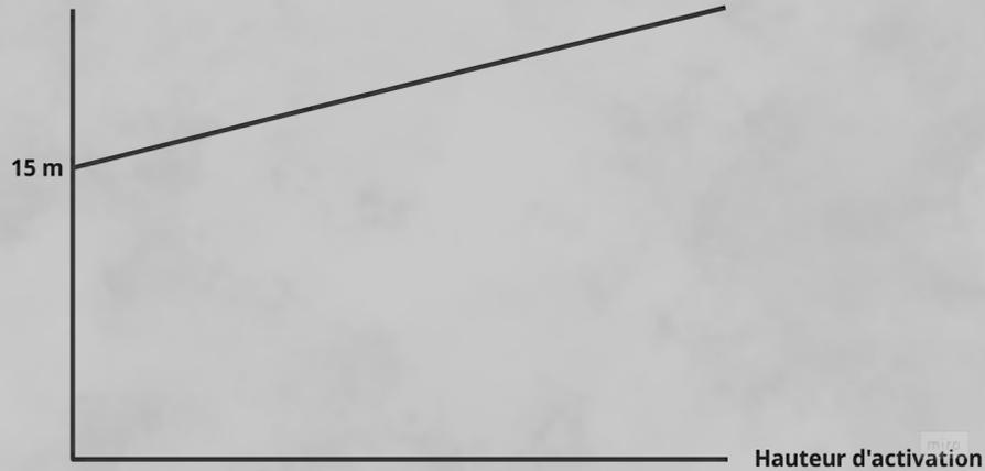
*Courbe du diamètre de l'onde de choc en fonction de la hauteur d'activation du pillonage*
